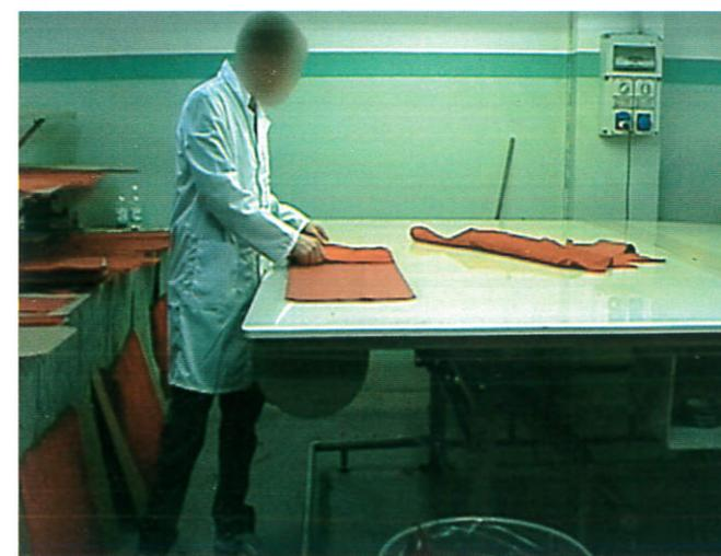
Infine, i pezzi tagliati sono *prelevati* dal tavolo, *accoppiati* (= piegati insieme) per il successivo utilizzo e sistemati in una "cassetta" destinata alle fasi successive di lavorazione. La durata media di un ciclo di taglio (= un manto di pelle) è di circa 22 min., con una variabilità abbastanza ridotta (rispetto alle altre mansioni dirette) fra 20 e 25 min.
