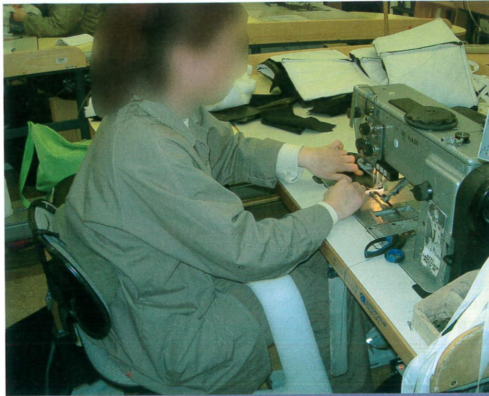
Oltre ai compiti appena descritti, gli addetti al cucito svolgono anche compiti di **movimentazione della cassetta** (contenente all'inizio i pezzi da cucire ed alla fine il rivestimento completo) il cui peso può variare dai 5 ai 20 Kg. (molto raramente anche 30 Kg) e di *movimentazione dei singoli pezzi*, che vengono in qualche modo sistemati per la successiva cucitura. Questi compiti, in qualche modo frammisti ai precedenti, occupano fra il 10 ed il 20% del tempo totale di ciclo.
