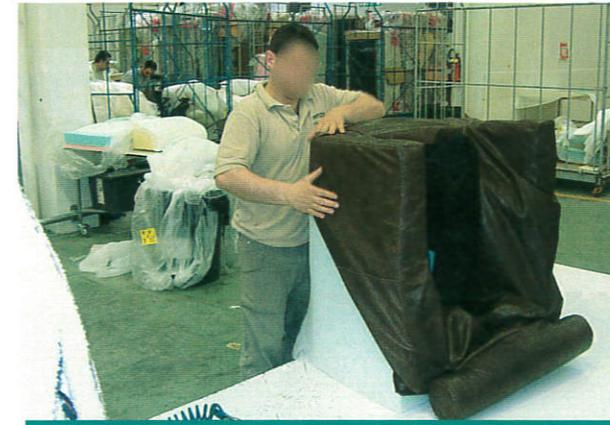
Tutte le singole parti vengono prelevate dall'unico carrello su cui sono stipate e man mano posizionate sul tavolo di lavoro (*movimentazione di pezzi pesanti*, come il fusto o la spalliera e *movimentazione di pezzi leggeri* come i singoli cuscini in gomma o piuma o le singole parti del rivestimento).
