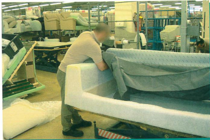
Il tappeziere esegue le diverse fasi descritte non necessariamente nella sequenza indicata poiché nella realizzazione del divano passa continuamente da una fase di lavorazione ad un'altra. La durata di un ciclo di lavoro per l'assemblatore è compresa fra i 15 e i 150 min. (passando dal semplice pouff, ai modelli più complessi), con una durata media compresa fra i 25 e i 35 minuti.
