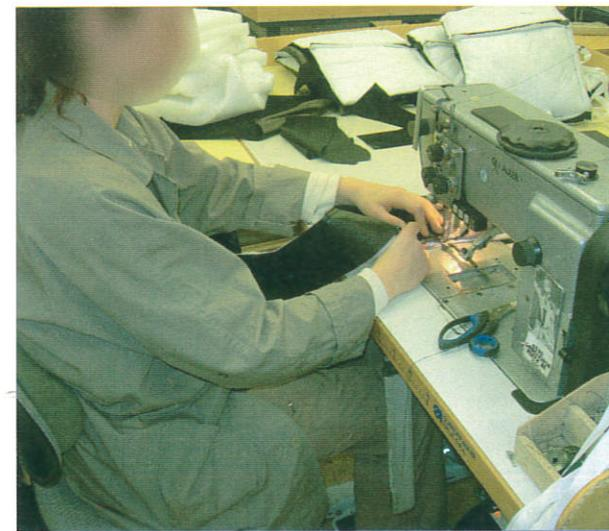
Infine il tutto torna alla macchina di cucito liscio per la fase di **chiusura finale**, che realizza un unico rivestimento o un numero comunque ridotto di parti di rivestimento, che saranno poi utilizzati tal quali dal tappezziere. La fase di chiusura finale può durare dai 10 ai 30 min. - media 17 min. - pari al 20-25 % del tempo totale di ciclo.
