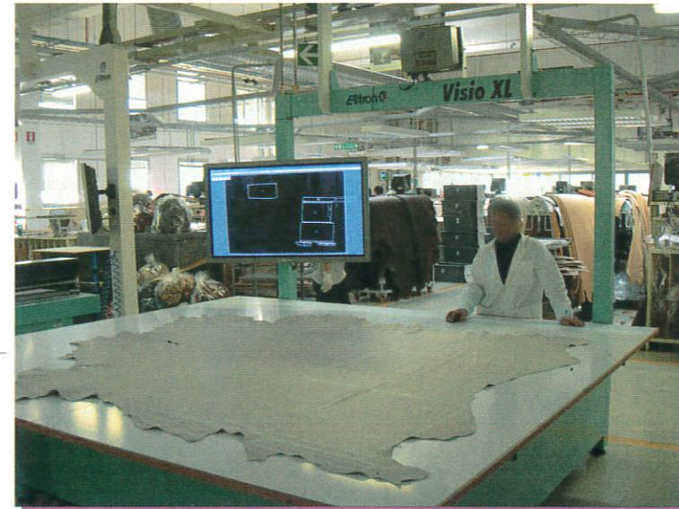
In alcune realtà industriali di maggiori dimensioni sono in fase di sperimentazione le apparecchiature per il taglio automatico, che comportano l'abbattimento dei rischi ergonomici.
