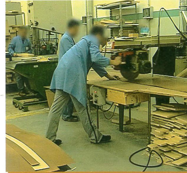
La realizzazione del mobile imbottito inizia con la produzione del fusto in legno (ed altri materiali come truciolato, masonite), realizzato dai "falegnami": alcuni operatori provvedono al taglio dei materiali, altri a lavorazioni particolari per praticare fori o singole sagomature sui pezzi ed infine l'addetto al montaggio provvede ad assemblare i singoli pezzi per realizzare il fusto stesso.
