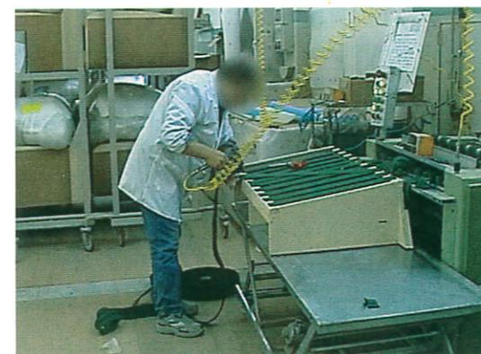
Gli **addetti alla cinghiatura** provvedono ad applicare sul fusto di legno le cinghie elastiche che sosterranno il rivestimento; la *cinghiatura* può essere effettuata esclusivamente in modalità *manuale*, per cui ogni singola cinghia viene fissata ad una estremità del fusto (del fondo o della spalliera del futuro divano), tirata manualmente e (contemporaneamente) fissata all'altra estremità.
