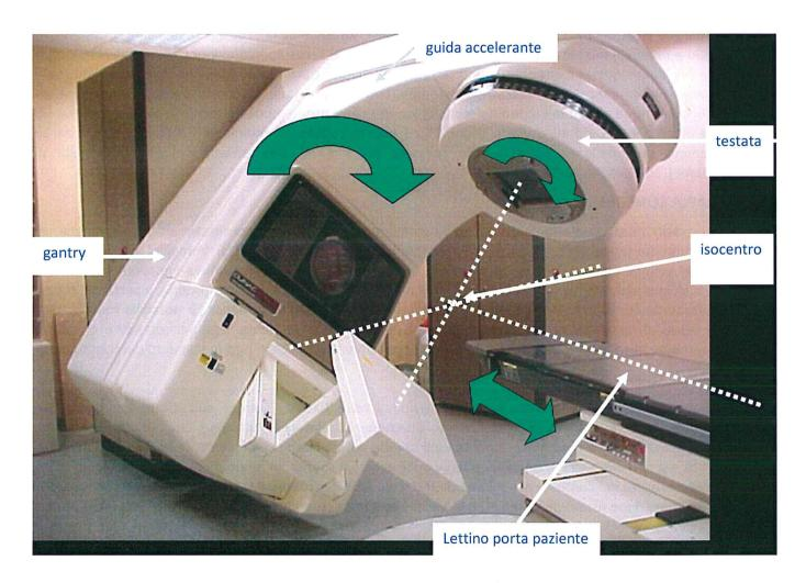
Le prestazioni erogabili da un LINAC dipendono dalle sue caratteristiche complessive quali la precisione dell'isocentro, la possibilità di lavorare senza filtri sul fascio, la capacità di erogare intensità di fascio maggiore, la quantità di tempo necessario ad erogare l'intensità di energia massima, la precisione del collimatore multilamellare, etc.
